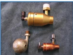
図 旋回式微細気泡発生装置
