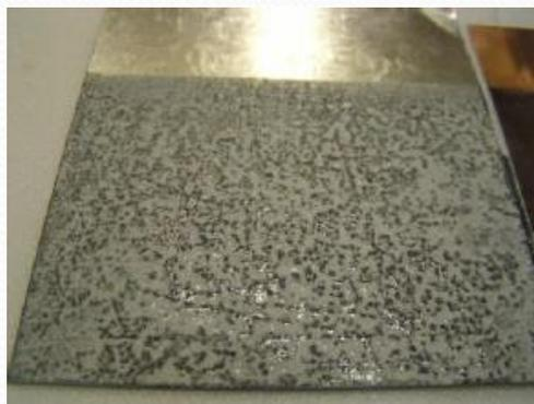
図 亜鉛板の腐食
