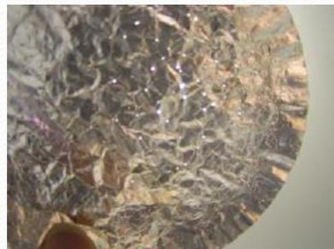
図 アルミホイルの腐食
