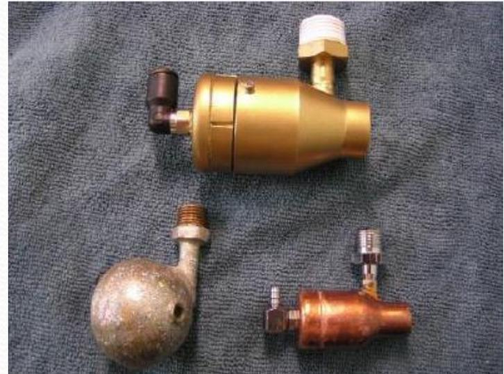
図 回転式微細気泡発生装置
