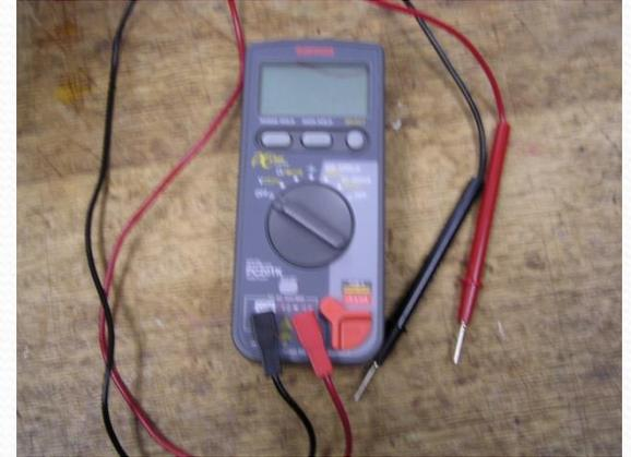
図 直流電圧/電流計
